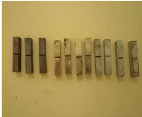
Figure 1. (d) Samples after corroding for 2400 hours
